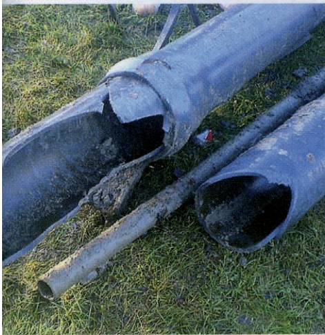
Den trasiga ledningen byttes ut med hjälp av styrd borrhning för vattenledningar enligt det nya systemet.
