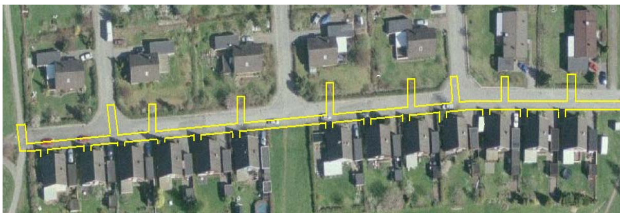
Figur 12. Ortofoto över hur en del av Lövängsvägen skulle ha sett ut om man tillämpade den konventionella metoden. Gula linjerna illustrerar ledningsgravar som är 2 meter breda och djupa.
