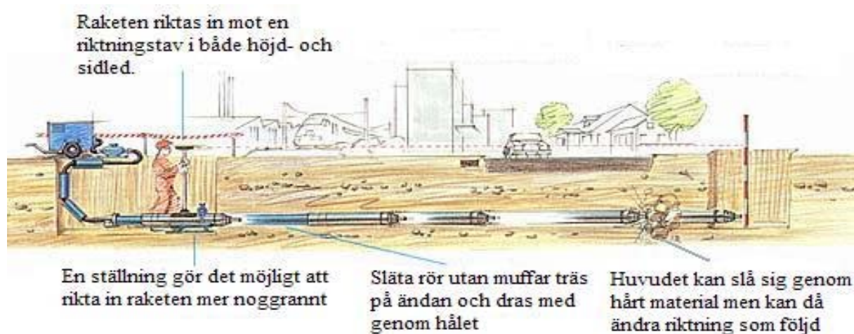
Figur 5. Principbild för hur jordraketen arbetar, källa www.gripsakeri.se
